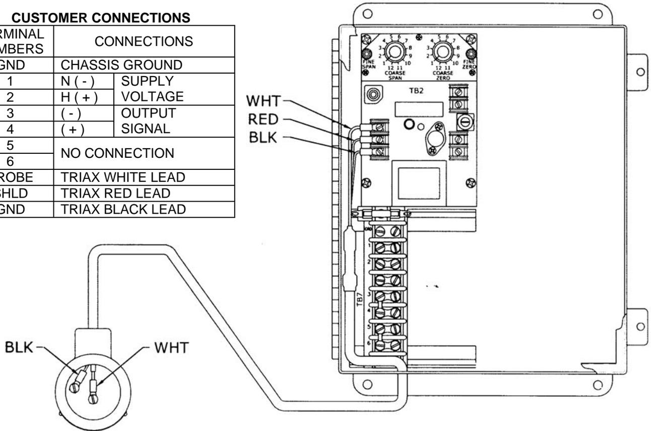
ELECTRICAL CONNECTIONS FOR LARGE WEATHERTIGHT ENCLOSURE
